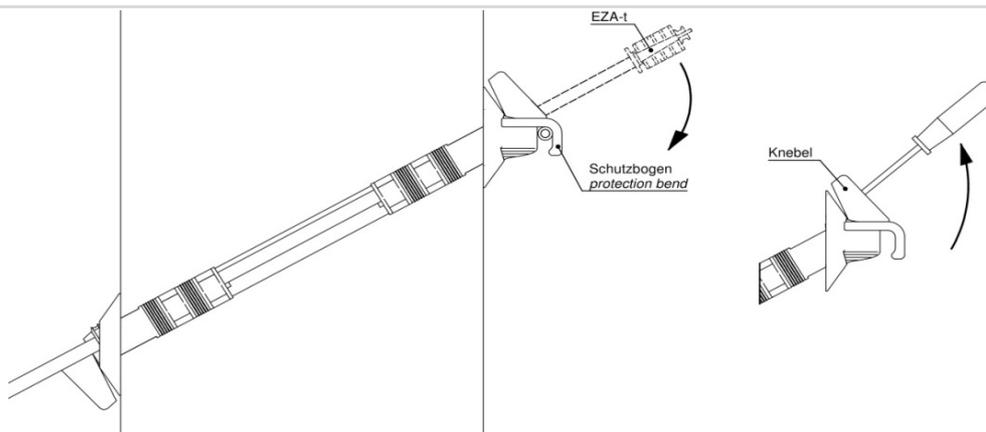
10) Belegte und unbelegte speedpipe-ground mit EZA-t verschließen (siehe Montageanweisung EZA-t).
