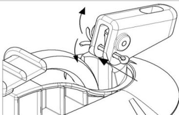
12) Mit den beigelegten Splinten können die Knebel vor unbeabsichtigtem Lösen gesichert werden. Dazu wird der Splint durch die dafür vorgesehene Bohrung gesteckt und an den Enden aufgebogen.
