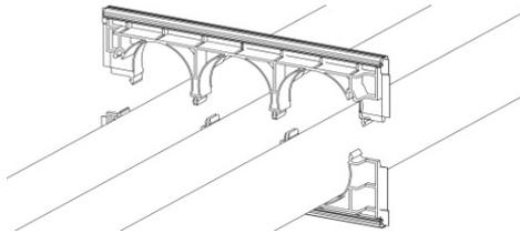
1) Ein EP-Endteil auf die Unterseite der Kabelkanalrohre klemmen, anschließend das zweite EP-Endteil um die Kabelkanalrohre schließen (auf Verzahnung achten).
