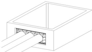
5) Die fertig montierte EP 3 x 110 in die Schachtöffnung schieben.
