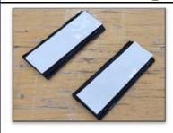
schwarzes Butyl-Dichtband auf 2x 35mm, 2x 30mm, 2x 25mm und 4x 15mm ablängen
