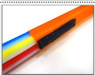
• den zusammengeklebten Streifen an einer geraden Seiten des Rohrverbandes aufbringen
