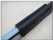
die zusammengeklebten Streifen an den geraden Seiten des Rohrverbandes aufbringen apply the bonded strips on the straight sides of the bundle
