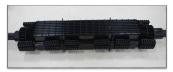
Die Verbindungsklammern mit der Hand vormontieren und anschließend mit dem Hammer gleichmäßig festtreiben.
