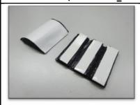
• schwarzes Butyl-Dichtband auf 1x 90mm, 1x 70mm, 1x 50mm, 1x 45mm, 1x 40mm, 1x 35mm, 1x 30mm, 4x 25mm, 4x 20mm und 3x 15mm ablängen cut black butyl sealing tape on 1x 90mm, 1x 70mm, 1x 50mm, 1x 45mm,
