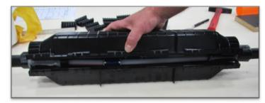
Die SRV-M MAXI mit der zweiten Halbschale verschließen.
