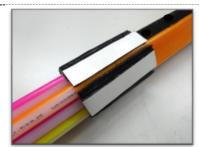
die Streifen an den geraden Seiten des Rohrverbandes aufbringen apply the strips on the straight sides of the bundle
