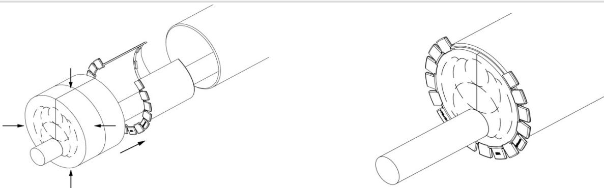
2) Kabeldurchmesser feststellen und Schaumstoffkörper anpassen.
