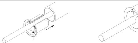
4) Kabeldurchmesser feststellen und Schaumstoffkörper anpassen.
