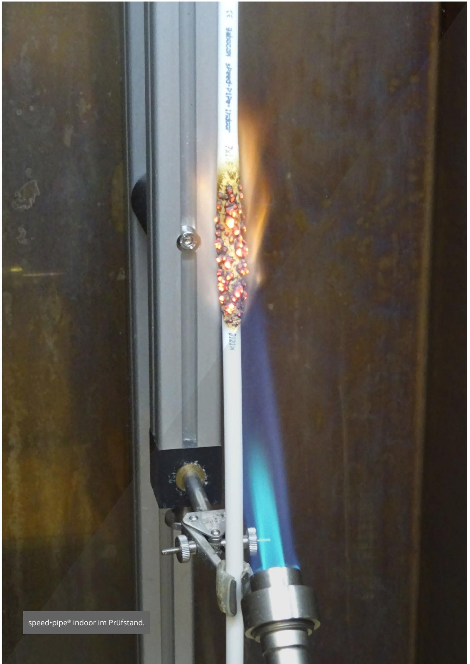
speed•pipe® indoor im Prüfstand.
