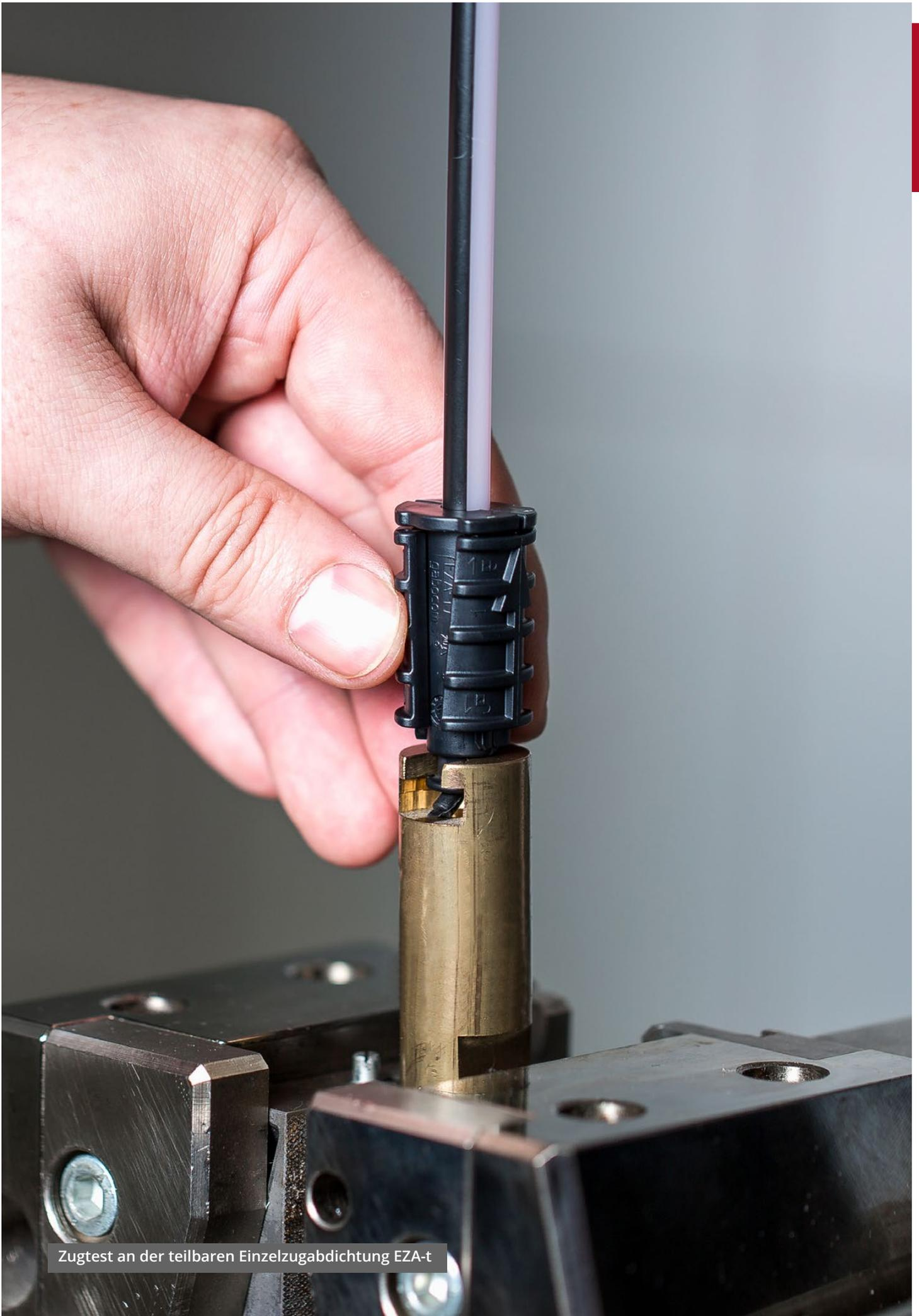
Zugtest an der teilbaren Einzelzugabdichtung EZA-t
